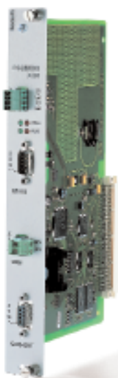
Scheda di controllo PSQ 6000 – per un controllo qualità ai massimi livelli nelle saldature a punti
